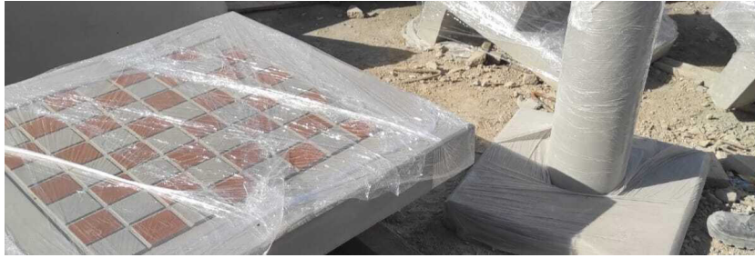
Figura 8 Acabado de color con químico en concreto arquitectónico, proyecto de Planta Opticretos. Fuente: Propia 2022.
